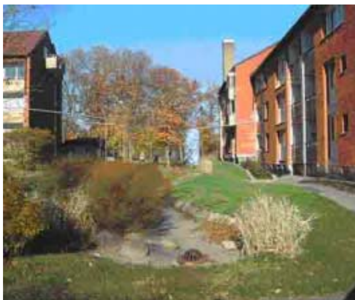
Fig 6 Exempel på lösning av lokalt omhändertagande av regnvattnet i gårdsmiljö
